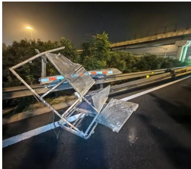
图 3 遭撞击变形的作业平台
