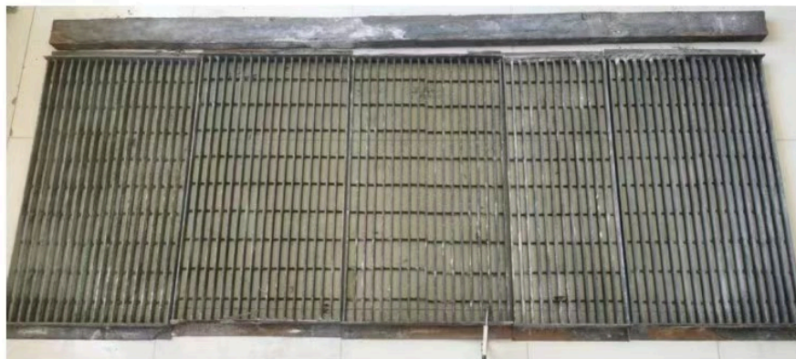
图2 事故现场发现的脱落槽钢及格栅踏板
