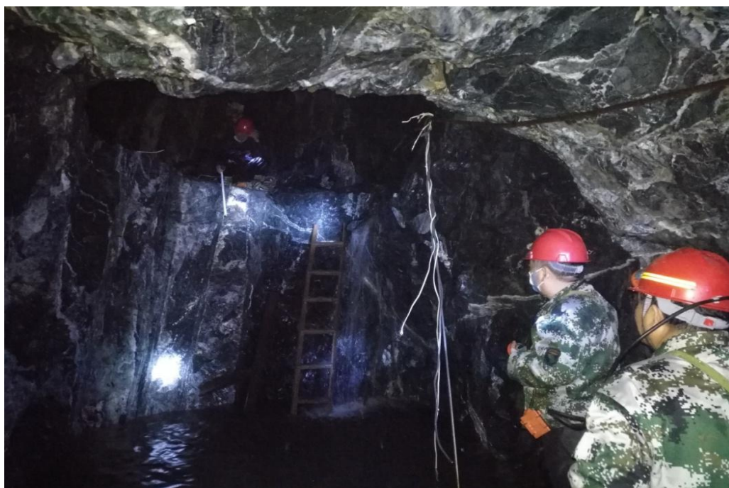
图 4 西井五中段西沿脉平巷透水口现场照片
